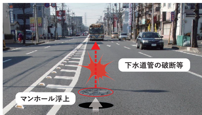
緊急輸送路の下水道管の耐震化
