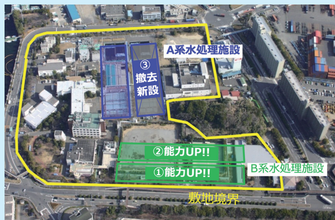
中部水再生センター立地状況と下水処理能力増強技術を活用した再構築イメージ
