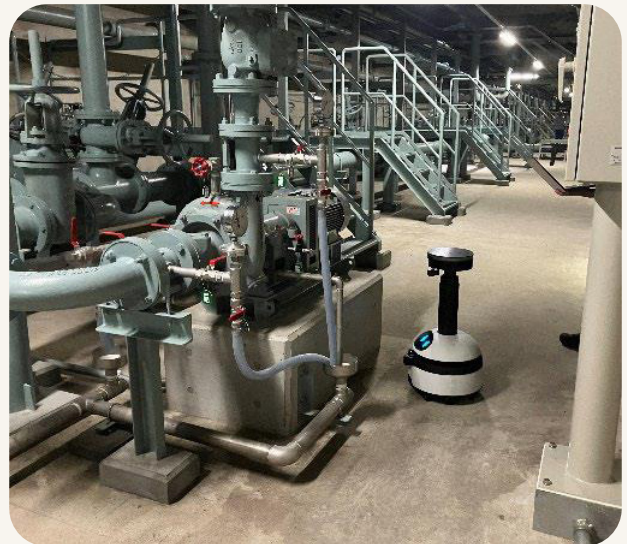
AGVでの自動巡回点検実験の様子
