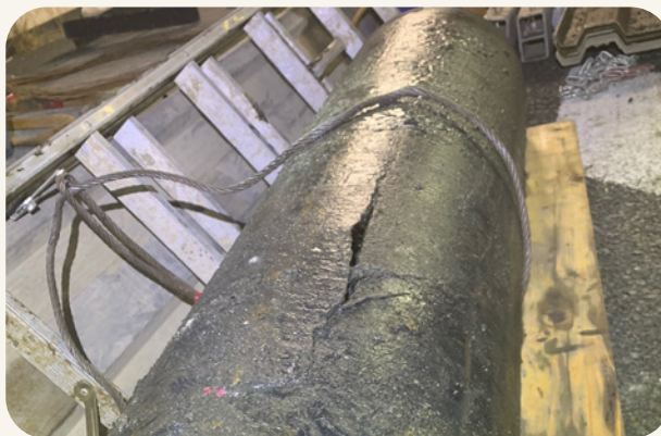
老朽化により腐食が進んだ送泥管
