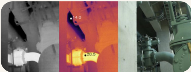
AIによる異常発熱検知実験
