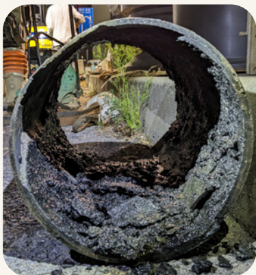
老朽化により腐食が進んだ送泥管
