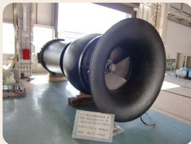
再整備後のポンプ設備
