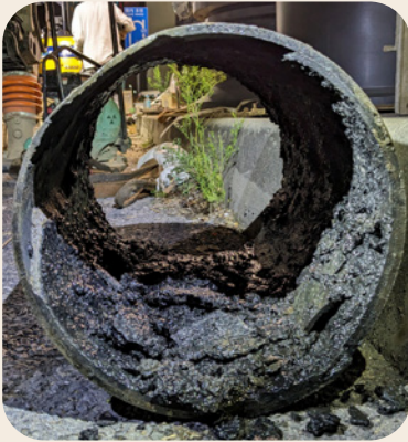
老朽化により腐食が進んだ送泥管
