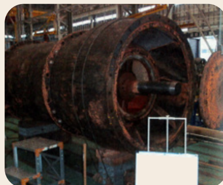
主ポンプ設備の修繕
