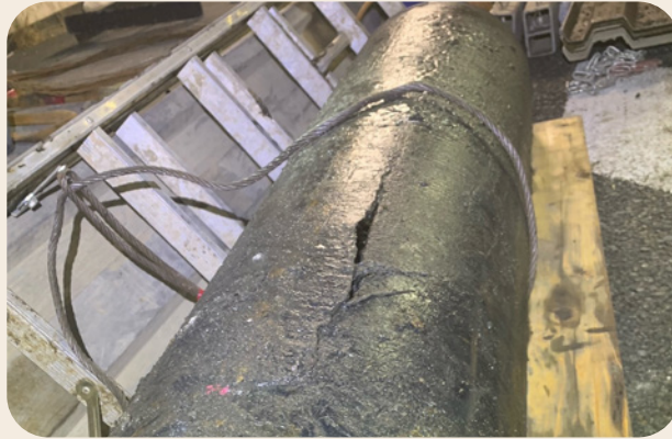
老朽化により腐食が進んだ送泥管
