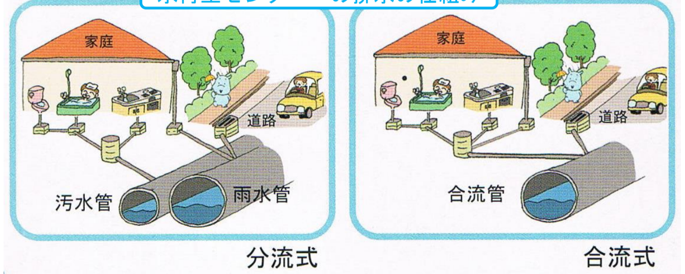
水再生センターへの排水の仕組み
