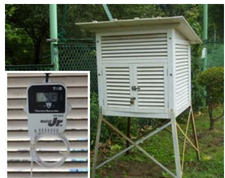
図1 小学校の百葉箱内に設置したサーミスタ温度計
