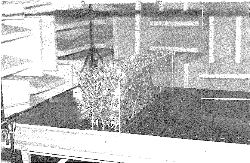
写真 II -9 遮音壁と植樹帯の併用実験 1 高さ0.22 m
