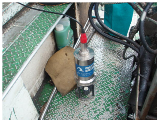
写真7(3) 多項目水質計 (左:表示部、右:センサー部)
