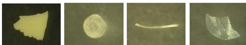
図 6 さまざまな形状のマイクロプラスチック (左から、破片、ビーズ (球)、糸状、フィルム (薄膜))
