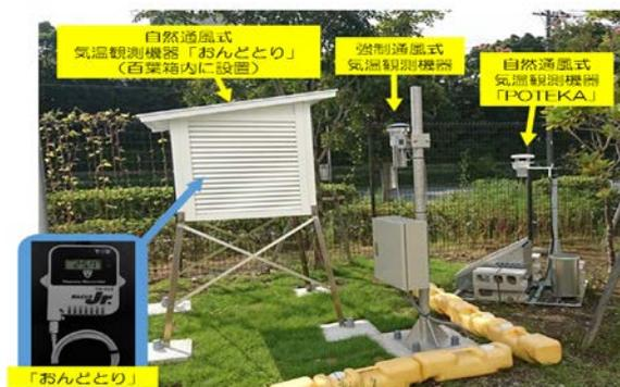
図 1 気温観測機器の設置状況
