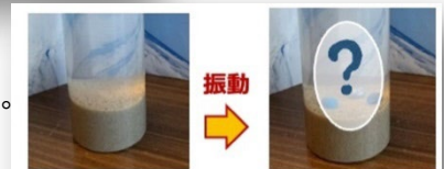
左：地盤の中にマンホールを模した虫ピンが 右：地震の揺れで液状化が起こり浮き上がり！
