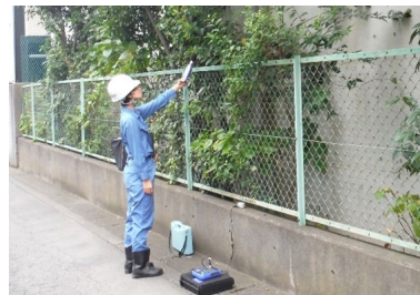
立入検査における 騒音及び振動測定の様子
