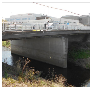
河川調査（橋の上から採水）の様子 ※写真の一部を加工しています
