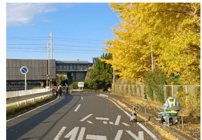
新幹線鉄道の騒音測定の様子 (作業員の左側に測定器具を設置)
