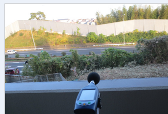
図 4-15 道路交通騒音の測定
