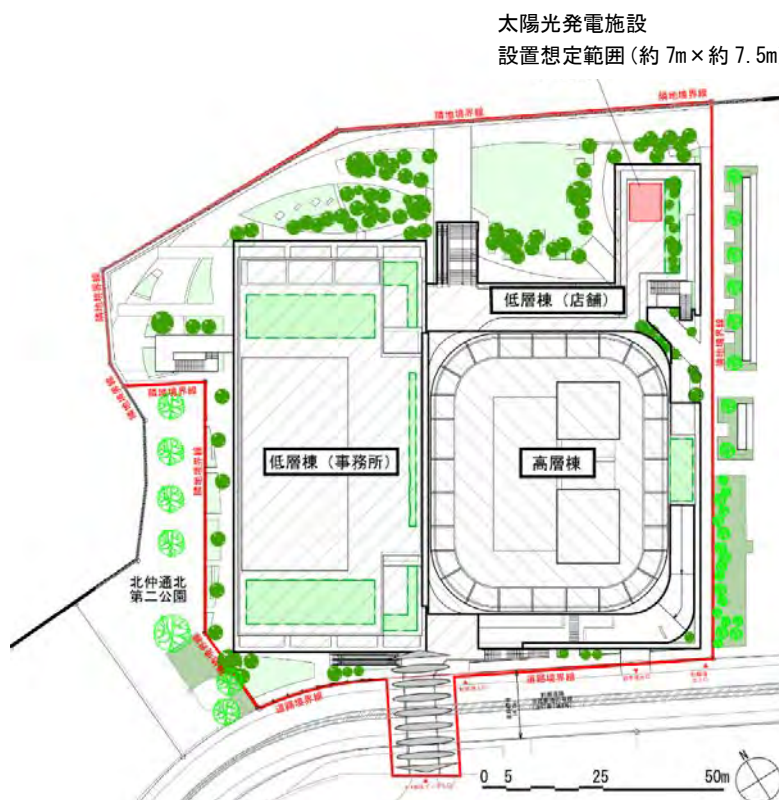
図 11-1 太陽光パネルの設置想定範囲
