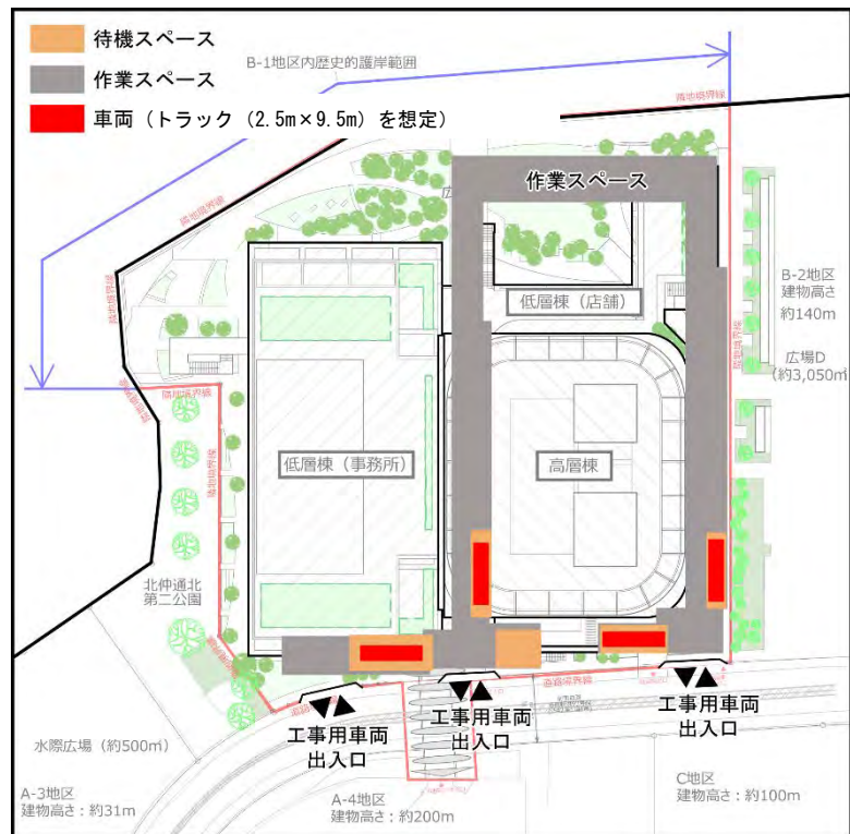
図 7-1 工事用車両の待機スペース
