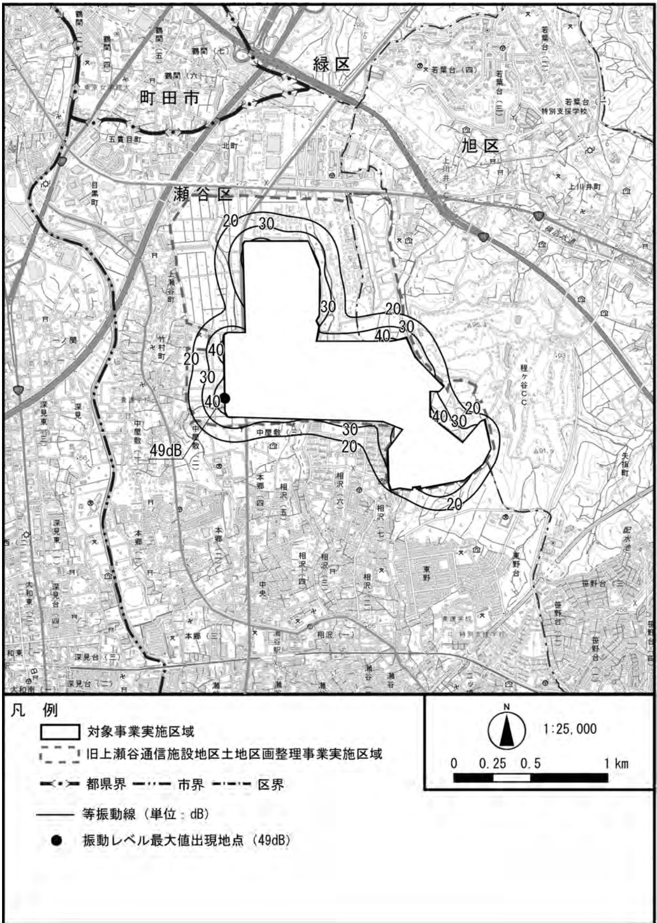
図 6.9-4 建設機械の稼働に伴う振動の予測結果 (撤去中: 本博覧会のみ)
