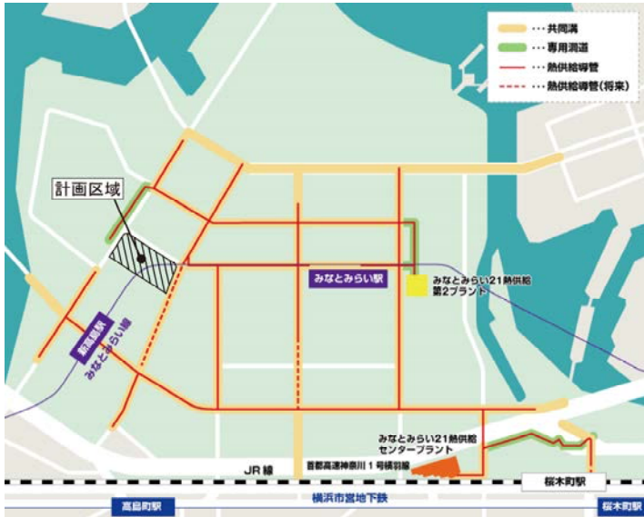
資料：「地域導管（供給システム）」（みなとみらい 21 熱供給株式会社、令和 4 年 3 月調べ） 図 2.1-4 みなとみらい 21 中央地区における地域冷暖房プラント及び共同溝の位置図
