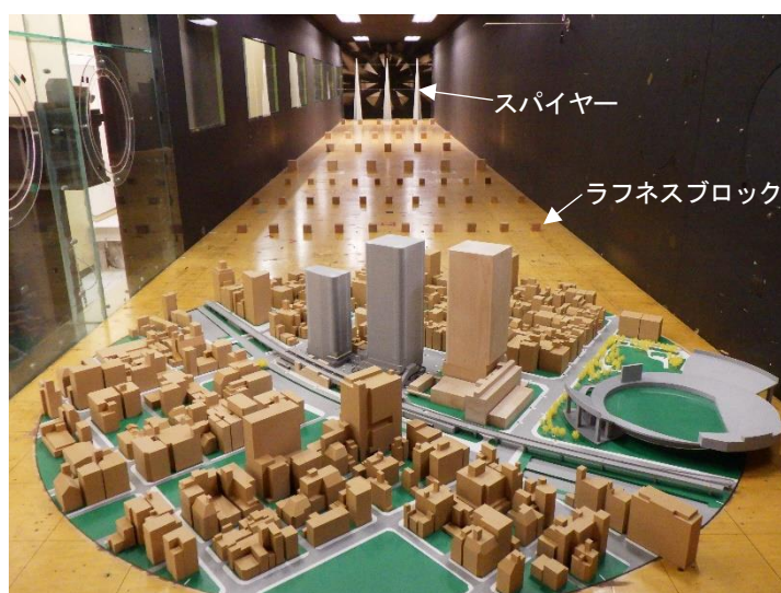
写真 6.10-2 ラフネスブロック及びスパイヤーの設置状況
