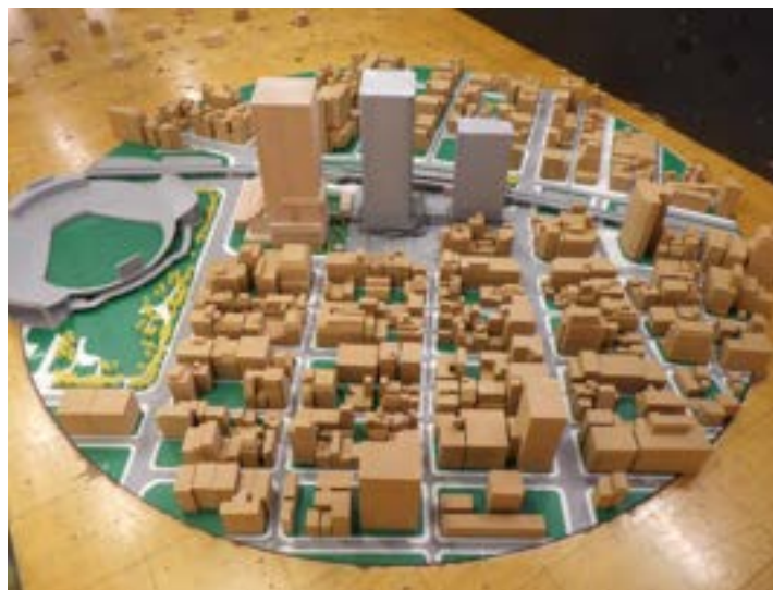
写真 6. 10-1 本実験で用いた風洞模型
