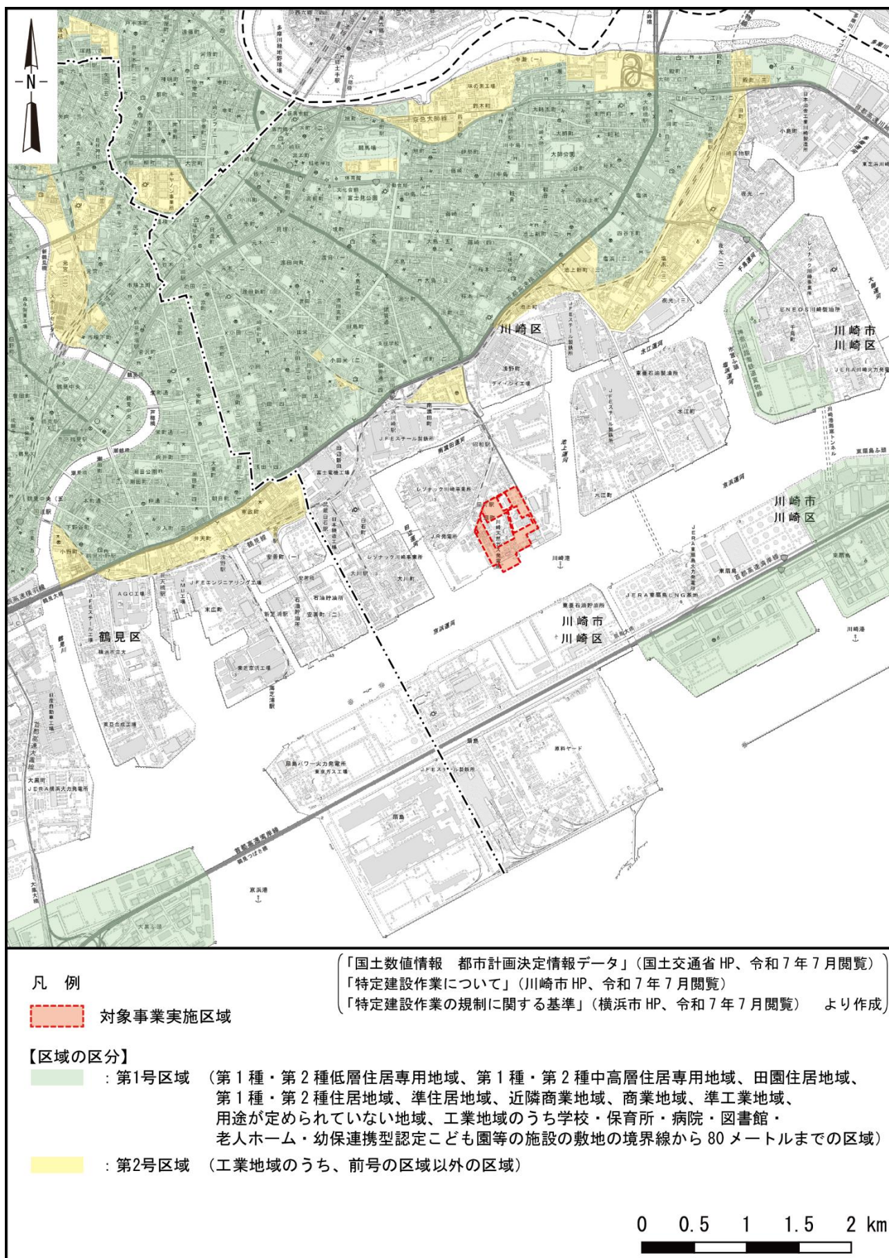
第 3.2-15 図 特定建設作業に係る規制の区域区分 (騒音・振動)
