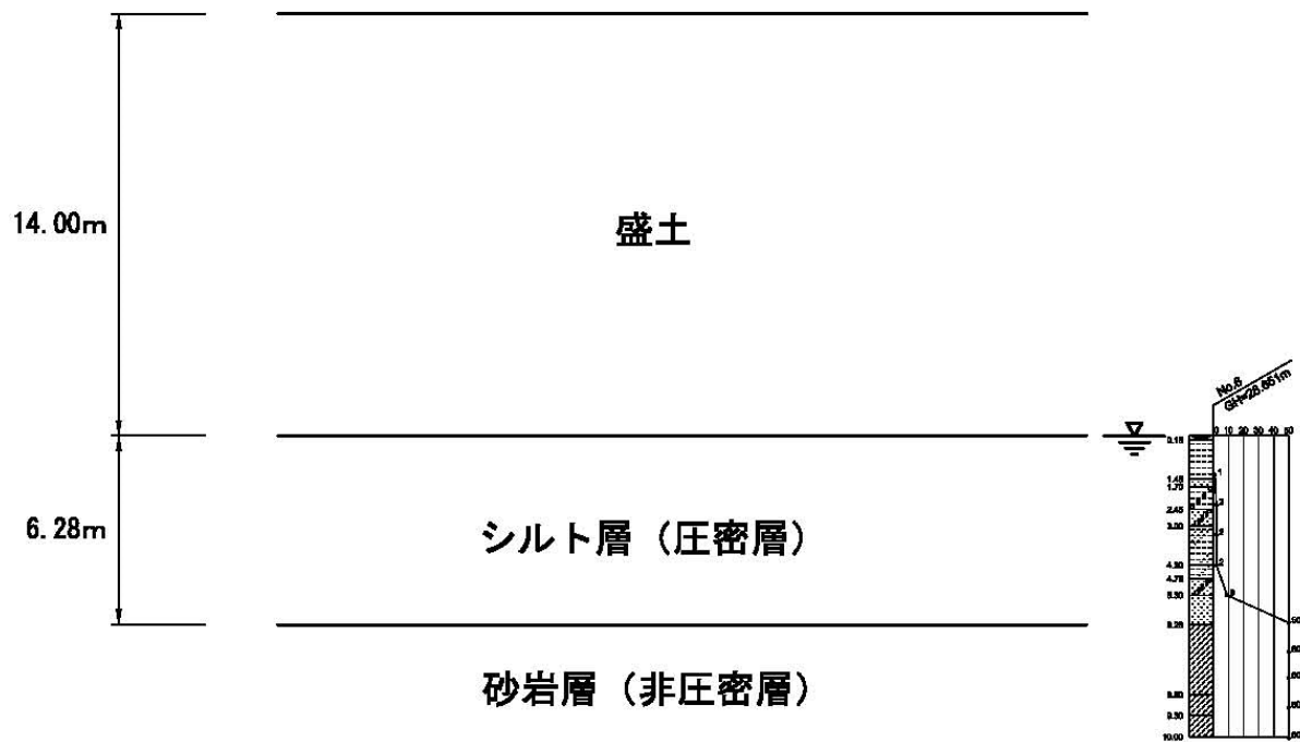
図 2-9 予測モデル断面①（ボーリング NO. 6）
