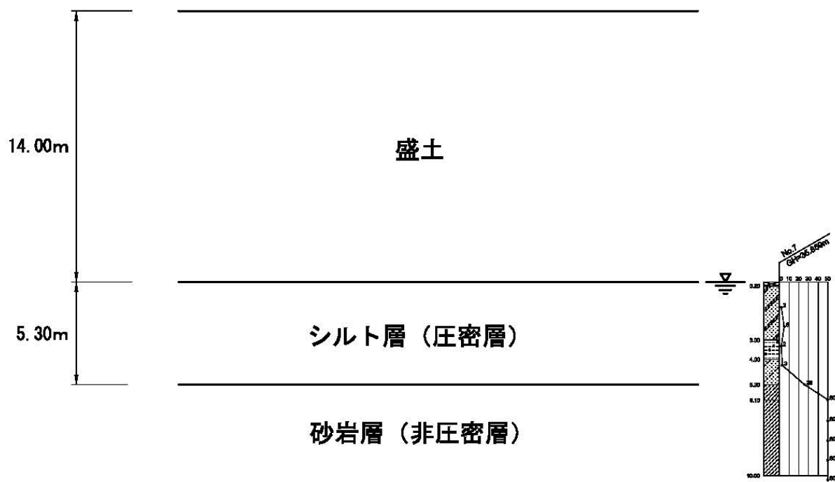
図 2-10 予測モデル断面②（ボーリング NO. 7）
