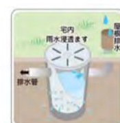
宅内雨水浸透ます
