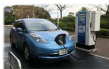
ごみ焼却工場で発電した再生エネ等電気 で充電する電気自動車
