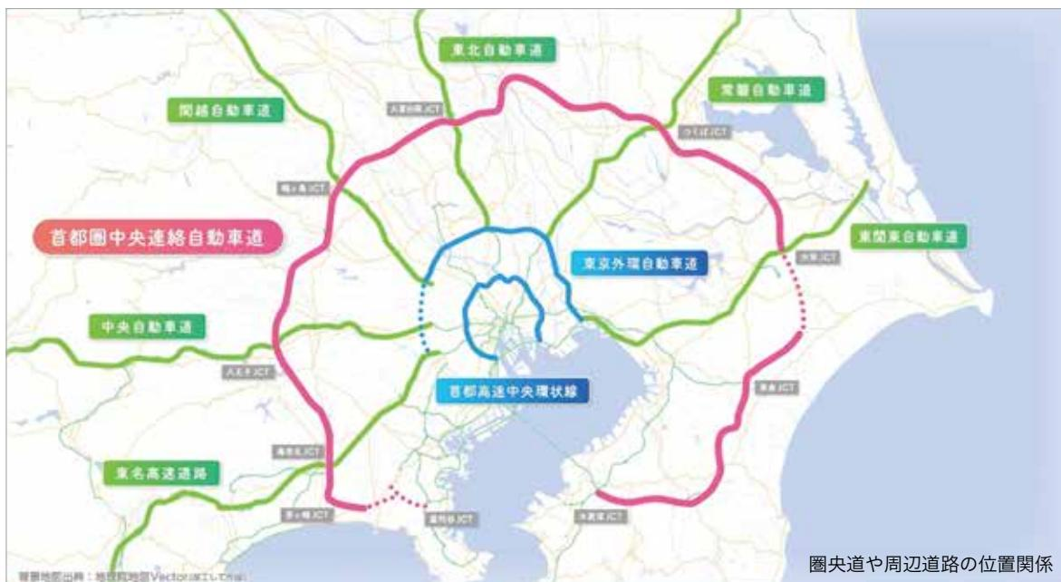
首都圏中央連絡自動車道（以下「圏央道」という。）は、東京都心から概ね半径40～50kmの位置に計画された首都圏環状道路で、延長約300kmの自動車専用道路である。横浜、厚木、八王子、筑波、成田、木更津等の中核都市を相互に連絡し、東京一極集中の是正を図ると共に、東名高速道路、中央自動車道等の放射道路を相互に連絡し、首都圏への流入交通を分散させ、混雑緩和を図る路線である。
