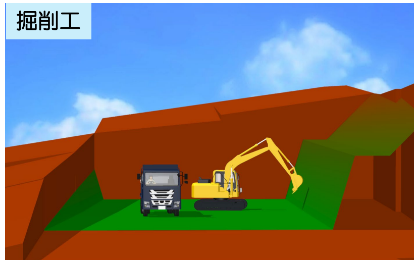
山を削り土砂を搬出します。
