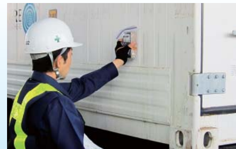
Imagem de um contêiner de carga tendo o nível de radiação medido
