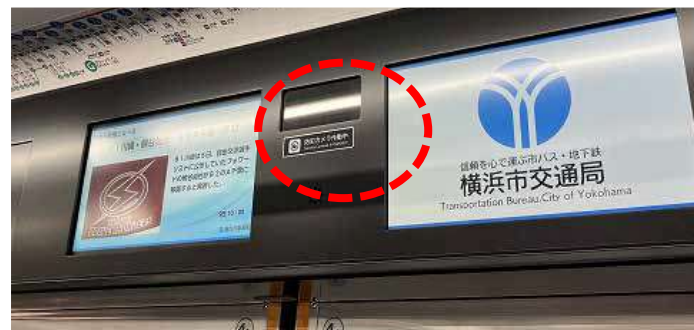
〈4000形車両に設置した防犯カメラ〉
