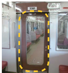
●貫通扉(延焼防止)
