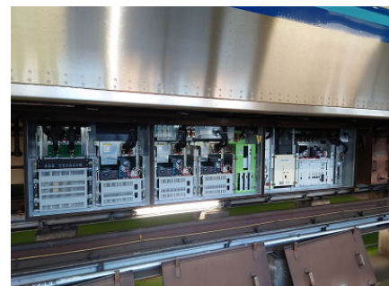
▲A T C 装置・・・列車速度を自動的に制御する装置
