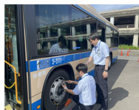
▲運行前点検（ボルト・ナット締め具合を確認）
