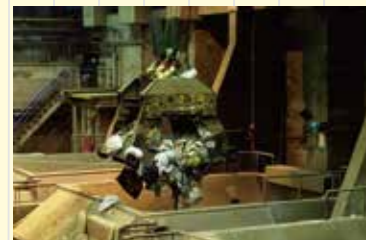
▲工場見学ではごみクレーンで焼却炉の入り口に、ごみを投入するところを間近で見学できます。
