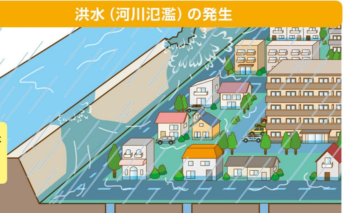
洪水(河川氾濫)とは、大雨によって河川などの水位が上昇し、堤防を越えて水があふれたり、堤防の土砂が流出して決壊したりすることです。家屋の倒壊や流出など、大規模な被害を引き起します。
