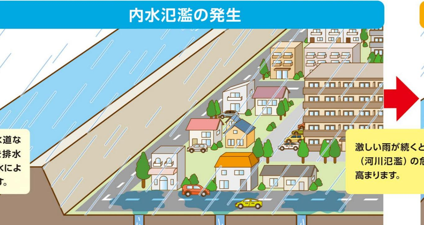
内水氾濫とは、雨の量が下水道などの排水能力を超えたときや、河川などの排水先の水位が高くなったりときに雨水を排水できなくなり、浸水することです。
