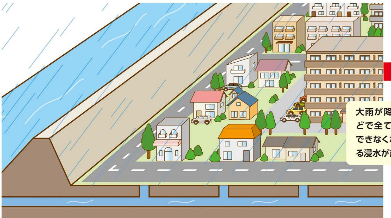
宅地に降った雨は雨水ますへ、道路に降った雨は道路側溝などに集まり、下水道や水路等を通して河川に排水されます。
