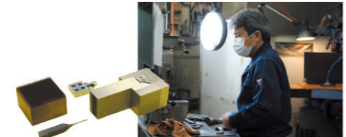
金属部品 角物研磨の様子
