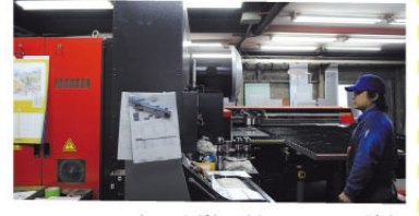
ターレットパンチプレス機で鉄板に孔をあける様子
