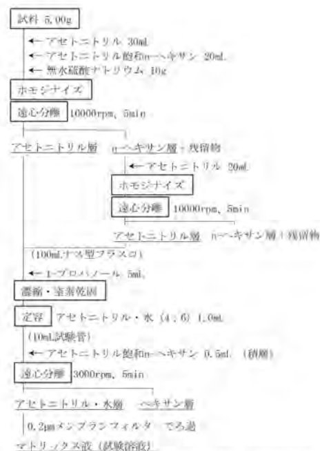
図1 マトリックス液 (試験溶液) 調製方法
