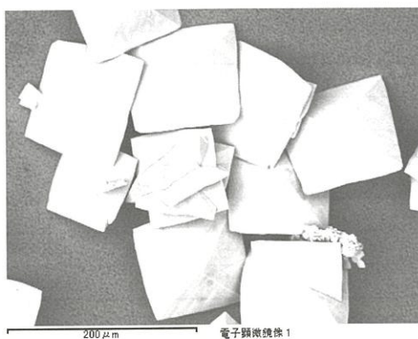
写真-1 容器 (No.6) に沈澱していた褐色沈澱物の電子顕微鏡像 (上) と電子線マイクロアナライザーによる元素分析 (下)
