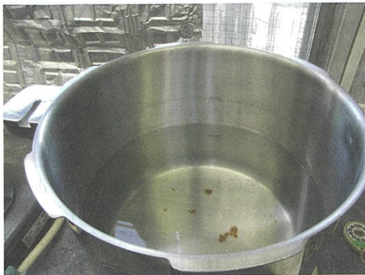
写真-1 ステンレス製の圧力寸胴鍋の中に生じた褐色浮遊物
