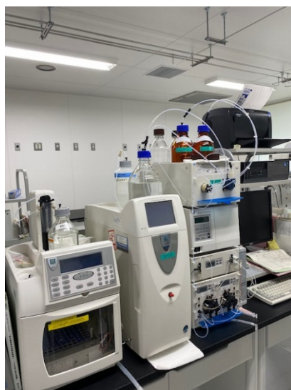
イオンクロマトグラフ-ポストカラム 吸光光度計(臭素酸分析用)
