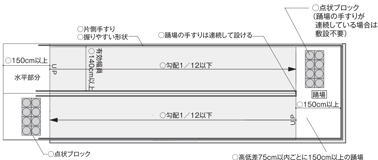
図7-3 折れ曲がる傾斜路の場合
