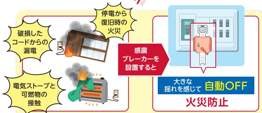
地震で停電した後、電気が復旧したときに、電気ストーブと可燃物の接触や、破損したコードから漏電して火災が発生することがあります。
