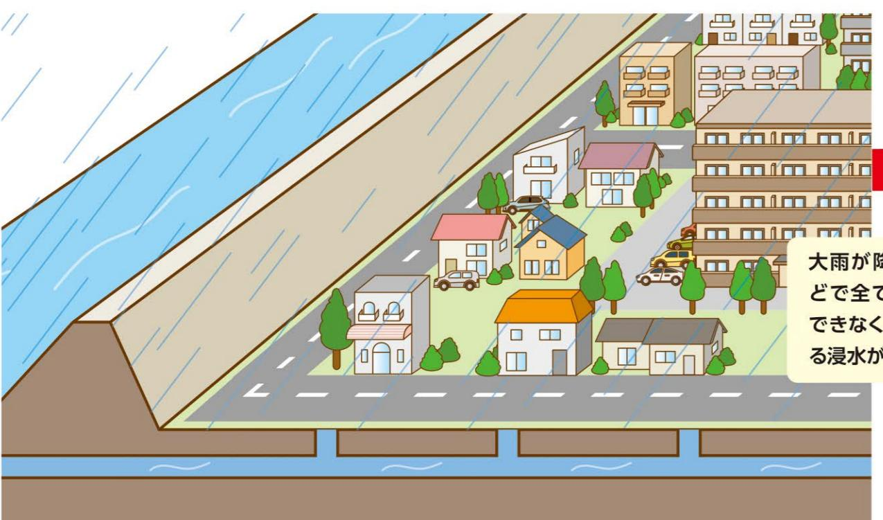
宅地に降った雨は雨水ますへ、道路に降った雨は道路側溝などに集まり、下水道や水路等を通して河川に排水されます。
