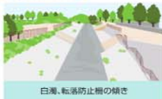
白濁、転落防止柵の傾き
