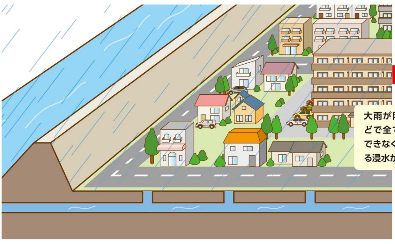
住宅に降った雨は雨水ますへ、道路に降った雨は道路側溝などに集まり、下水道や水路等を通して河川に排水されます。
