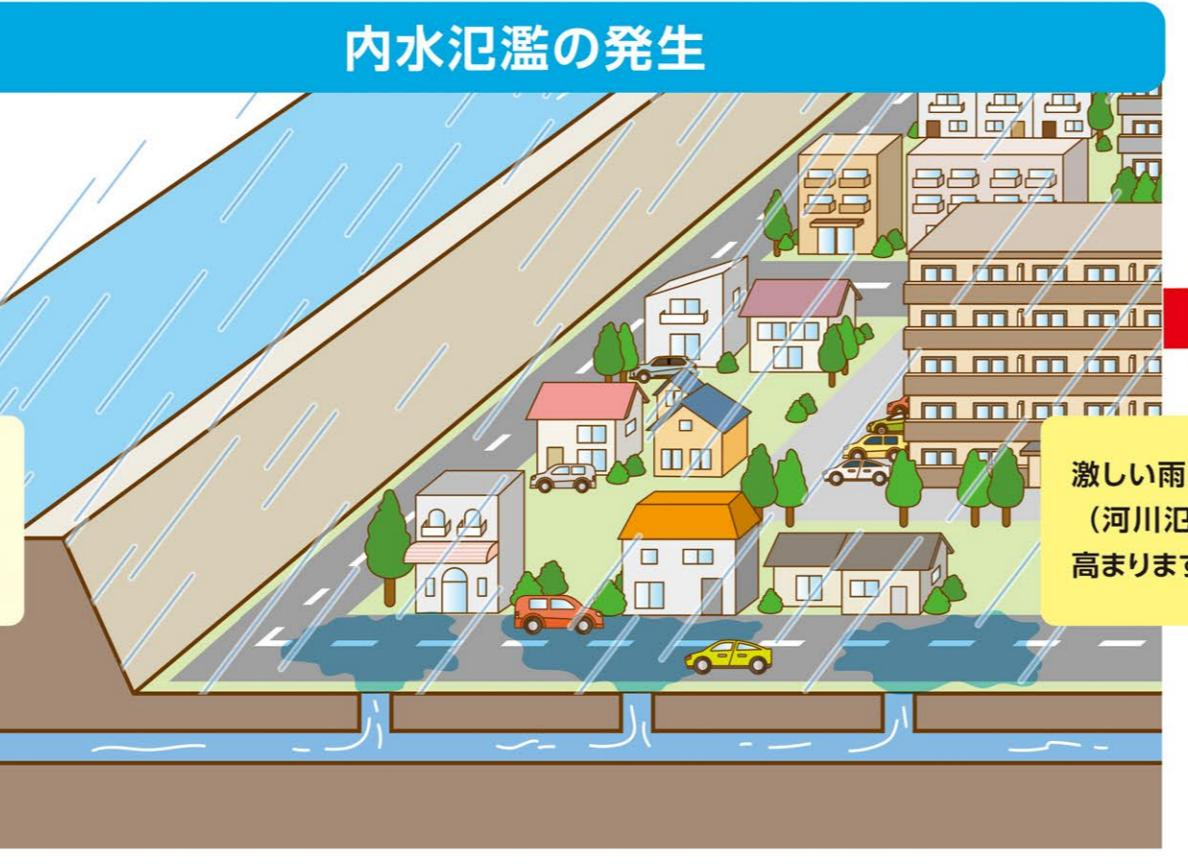
内水氾濫とは、雨の量が下水道などの排水能力を超えたときや、河川などの排水先の水位が高くなったときに雨水を排水できなくなり、浸水することです。
