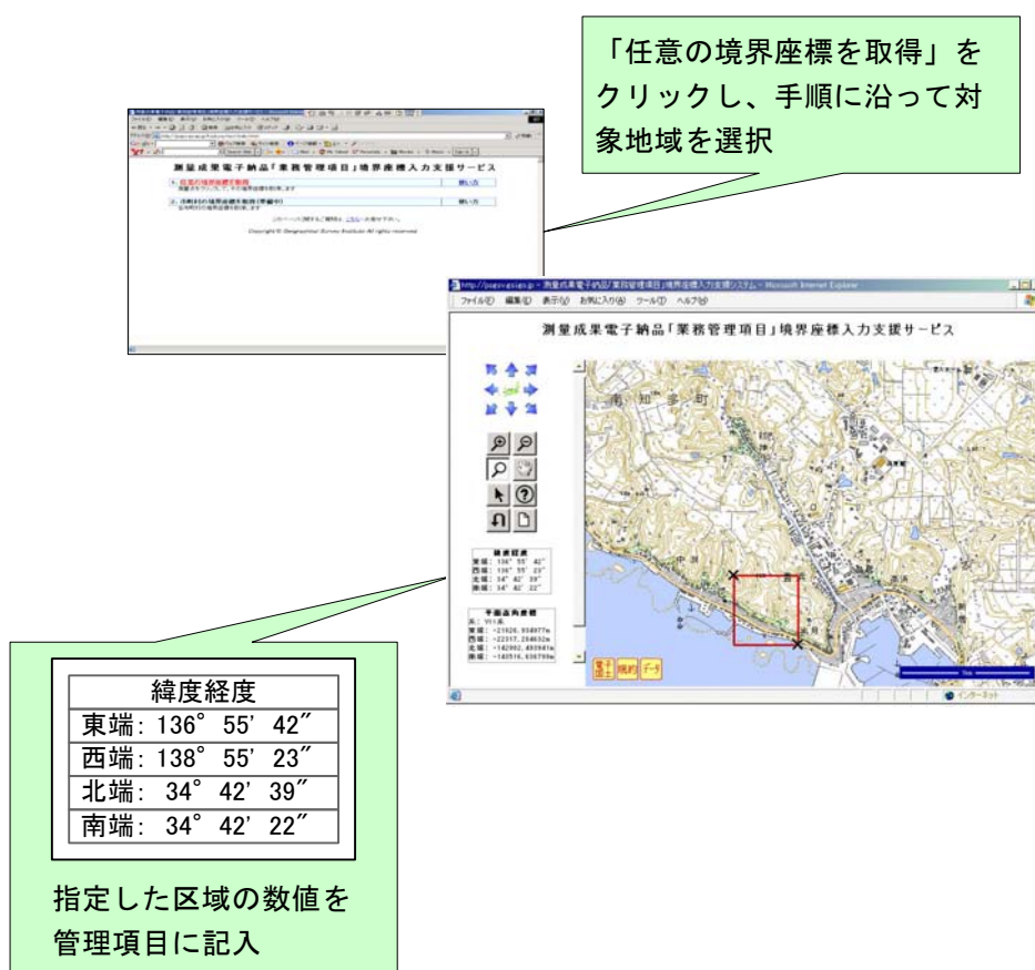
図 5-4 測量成果電子納品「業務管理項目」境界座標入力支援サービス
