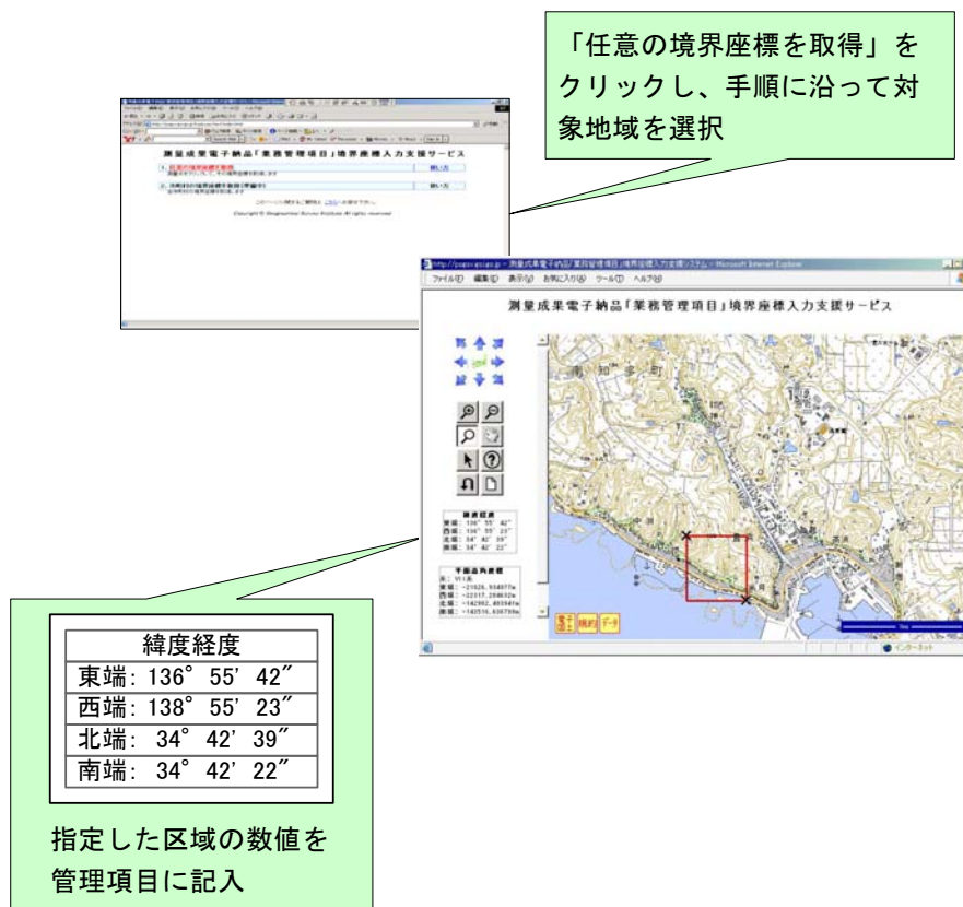
図 6-4 測量成果電子納品「業務管理項目」境界座標入力支援サービス
