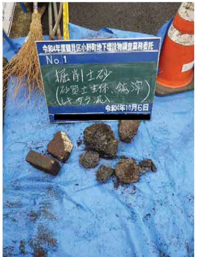
掘削土砂 (砂質土、鉍滓、レキ、ガラ)
