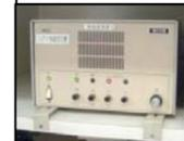
指令回線が断線した場合のバックアップとして、災害出場指令等を受信する装置です。
