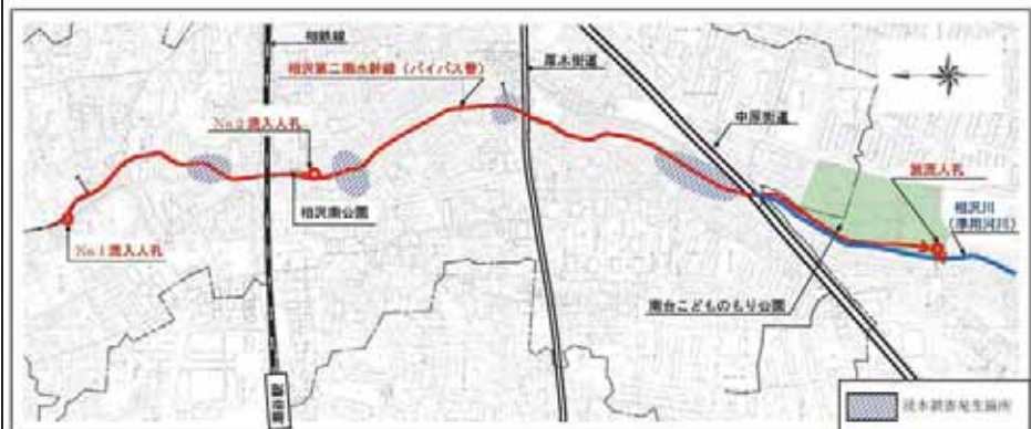
浸水状況と対策計画図
