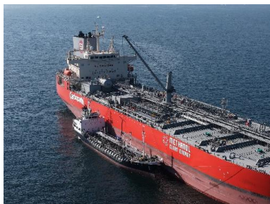
図47 Ship to Shipメタノールバンカリング/メタノールバンカリングシミュレーション
