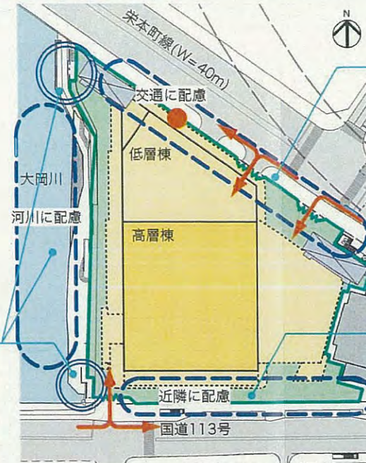
凡例：← 工事車両動線
