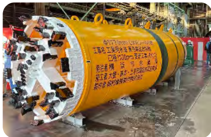
1工区を掘進したシールドマシン(全長約10m)
