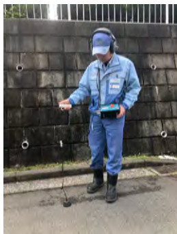
漏水調査の様子
