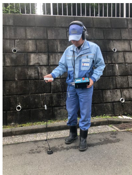
漏水調査の様子
